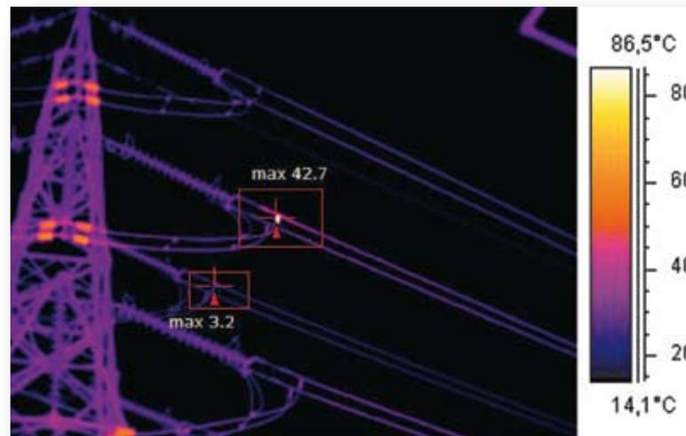
Immagine realizzata con una risoluzione di 320x240 pixel e una sensibilità termica di 50 mK. Grazie al maggior numero di pixel è possibile una lettura più precisa della temperatura nel punto caldo.
