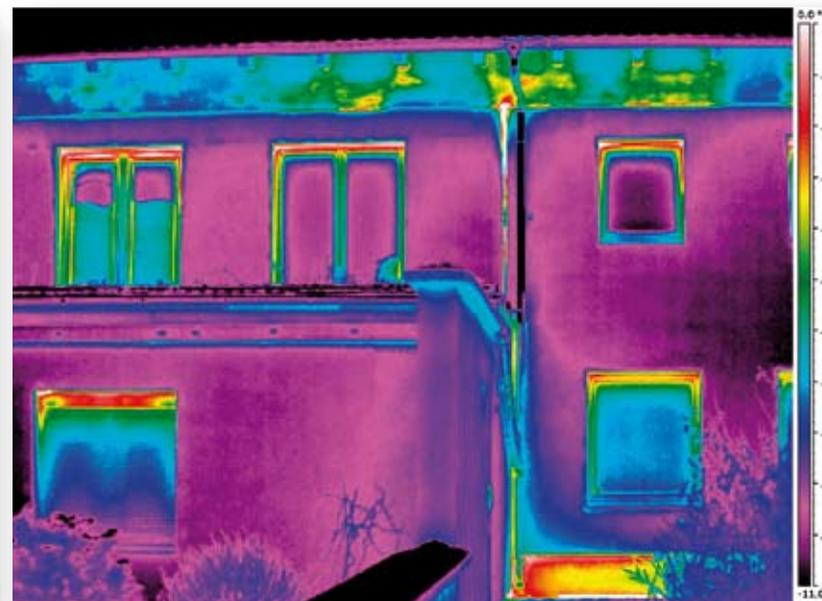
Immagine realizzata con una risoluzione di 640x480 pixel e una sensibilità termica  $< 45\text{ mK}$ . Grazie al maggior numero di pixel è possibile ottenere un'immagine più chiara e dettagliata che garantisce letture più precise e report di alta qualità.
