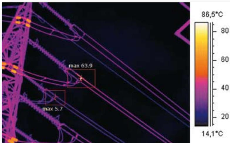
Immagine realizzata con una risoluzione di 640x480 pixel e una sensibilità termica di 45 mK. Il punto caldo è ora chiaramente visibile e, grazie al maggior numero di pixels, è possibile una lettura ancora più precisa della temperatura nel punto caldo. Risulta ora evidente che la linea elettrica presenta un problema.
