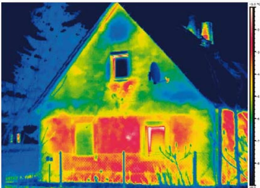
Immagine realizzata con una risoluzione di 320x240 pixel e una sensibilità termica  $< 50\text{ mK}$ .
