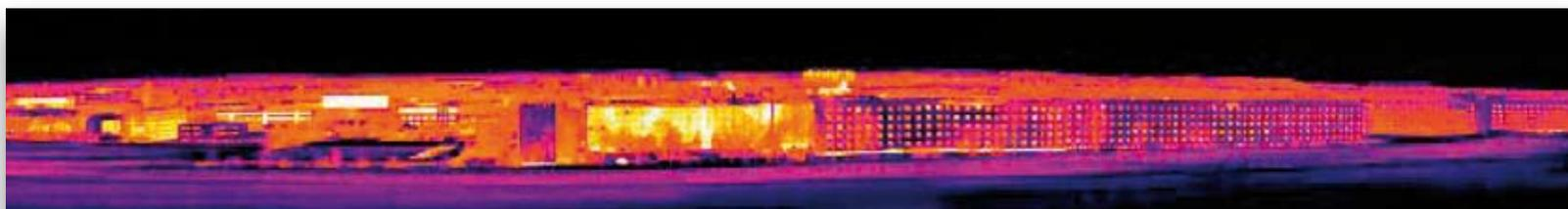
Immagine realizzata con funzione Panorama con una risoluzione di 200x150 pixel e una sensibilità termica < 70 mK.
