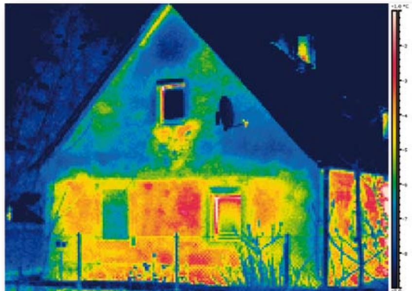
Immagine realizzata con una risoluzione di 200x150 pixel e una sensibilità termica  $< 70\text{ mK}$ .
